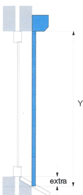
Montage 'op de dag' zijaanzicht HTF geleider (G)
